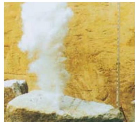
薬剤の噴出状況（鉄砲現象） 噴出現象は3～4回連続して起きます
