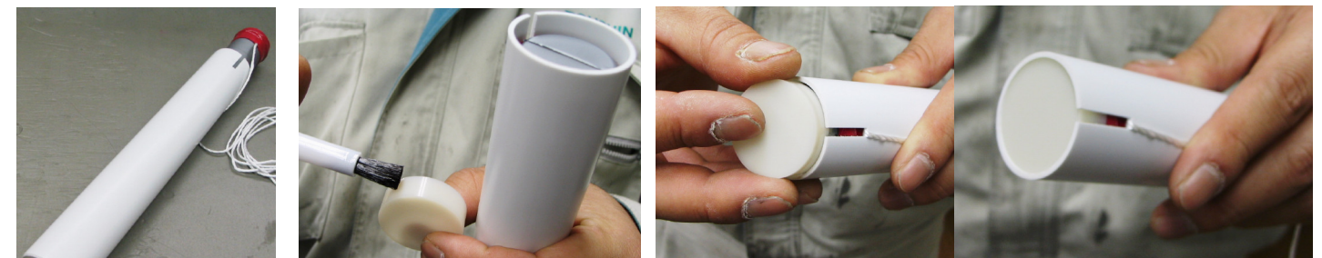
カートリッジにダイレックス薬筒のみを装填、必ず着火具側を奥にして挿入する
